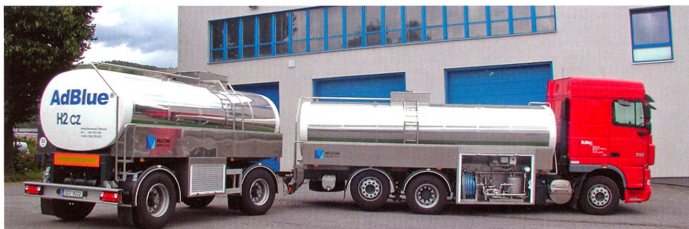
Nerezová izolovaná cisternová souprava o celkovém objemu 25 000 litrů. Hmotnost cisternové nástavby včetně armaturní skříně vybavené měřicím zařízením od firmy GEA Diessel bez podvozku je pouze 3190 kg a pohotovostní hmotnost přívěsu vlastní konstrukce firmy MILCOM® servis, je jen 4400 kg
